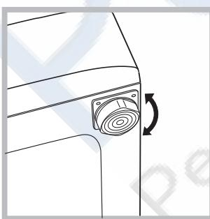
После установки машины на место проверьте по уровню горизонтальность верхней крышки корпуса, отклонение горизонтали должно быть не более 2°.
